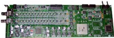
两通道声发射卡 PCI-2
